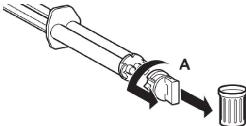
1. Draai vóór plaatsing van de mengcanule de sluitkap [A] of de gebruikte mengcanule 90° linksom, trek los en gooi weg.
