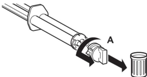
1. Vor dem Aufsetzen der Mischkanüle die Verschlusskappe [A] oder benutzte Mischkanüle nach Drehung um 90° gegen den Uhrzeigersinn abziehen und verwerfen.
