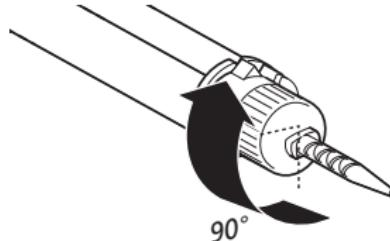
4. Het materiaal wordt tijdens het uitstromen in de canule gemengd en kan direct worden aangebracht.
