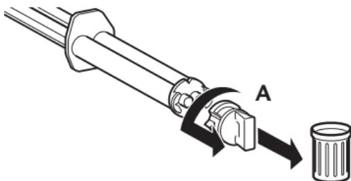
1. Prima di applicare la cannula di miscelazione, rimuovere e gettare il tappo di chiusura [A] o la cannula di miscelazione usata ruotandoli di 90° in senso antiorario.
