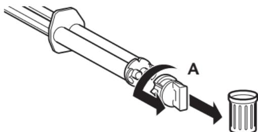
1. Перед установкой смесительного наконечника снимите колпачок [A] или использованный смесительный наконечник, повернув его против часовой стрелки на 90°, и выбросьте.
