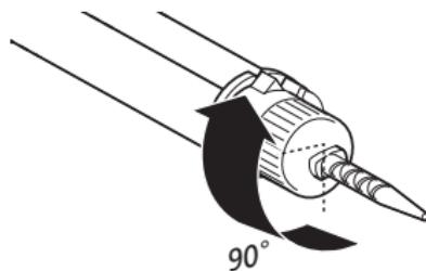
4. Al dispensarlo, el material se mezcla en la cánula y se puede aplicar directamente.
