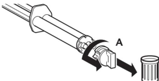
1. Avant la mise en place de la canule de mélange, tourner le bouchon [A] ou la canule de mélange utilisée de  $90^{\circ}$  dans le sens horaire et la jeter.
