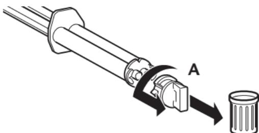
1. Antes da colocação da cânula de mistura, retirar a tampa [A] ou a cânula de mistura usada, rodando-a 90° para a esquerda, e descartar.
